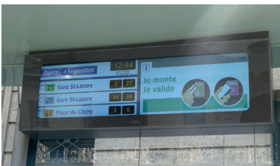
Affichage dynamique en couleur des temps d'attente sur le réseau de bus du STIF permettant un bon contraste (source : ©RATP)
