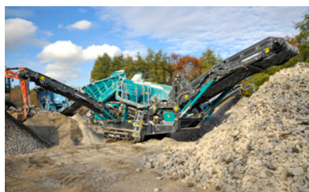
Intervention du concasseur mobile sur l'aire de transformation des matériaux
